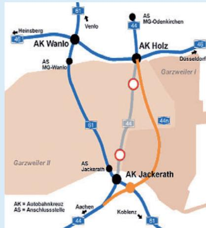
Die drei Autobahnkreuze (AK) Jackerath, Holz und Wanlo bilden ein Dreieck, das durch die Verlegung der A 44 etwas an Form verliert. Gut zu erkennen das alte AK Jackerath (schwarzer Punkt) und das neue AK Jackerath nach Verlegung (gelber Punkt) in Höhe des Guts Kaiskorb.
