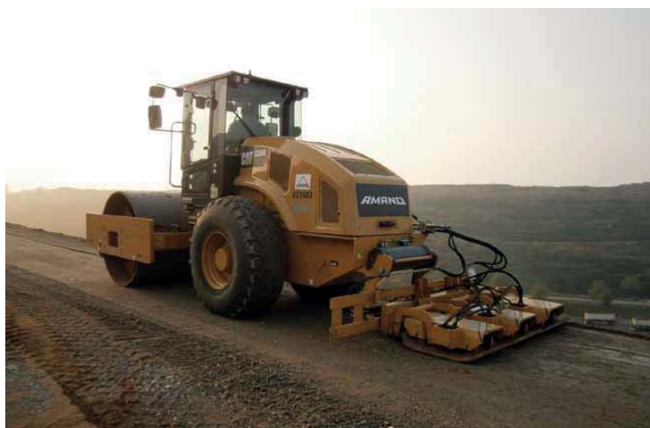
Mit Plattenverdichtern, Anbaugeräten, die Amand häufig nutzt, wird eine hohe Nachverdichtung der Oberfläche angestrebt. Fotos: (2) Amand
